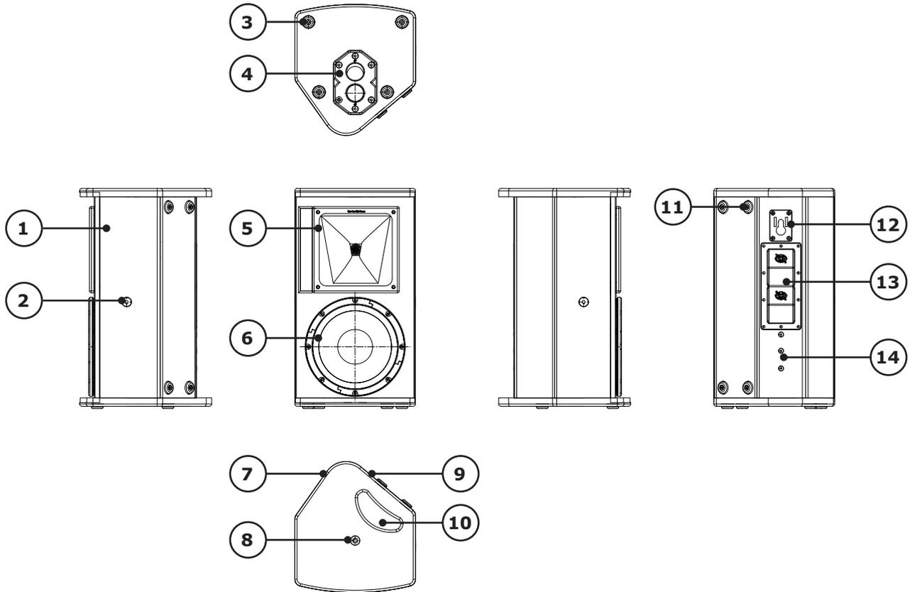
01. 15 mm Multiplexgehäuse, Oberfläche Polyurea Beschichtung.
